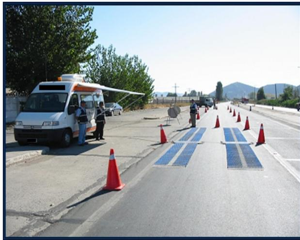
**Figura 3 - Balanzas Portátiles para Pesaje Estático por Ejes**
