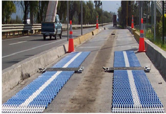
**Figura 2 - Balanzas Portátiles para Pesaje Dinámico/Estático por Ejes**
