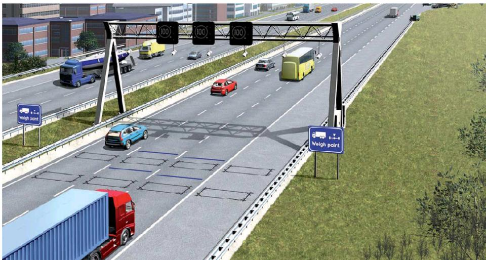
**Figuras 9 y 10 - Sistemas WIM (Weight In Motion): Sensores piezoeléctricos; Sensores de cuarzo; BendingPlates; Placas Unicell. No son legales para sancionar sino sólo para preseleccionar vehículos a controlar**
