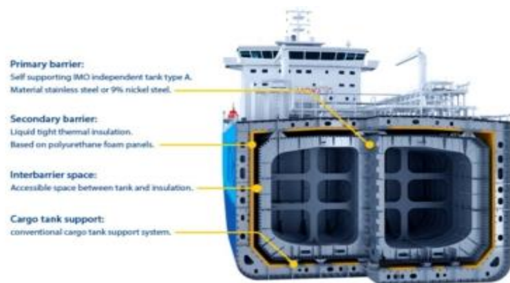
14 - Tanque tipo "A" (LNT)
