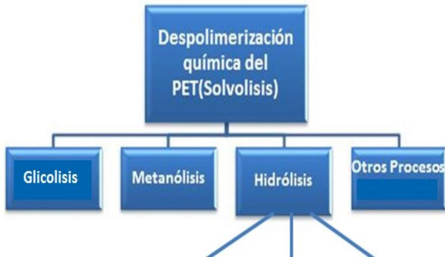
**Fig. 7.6 Tecnologías de despolimerización química del PET**
