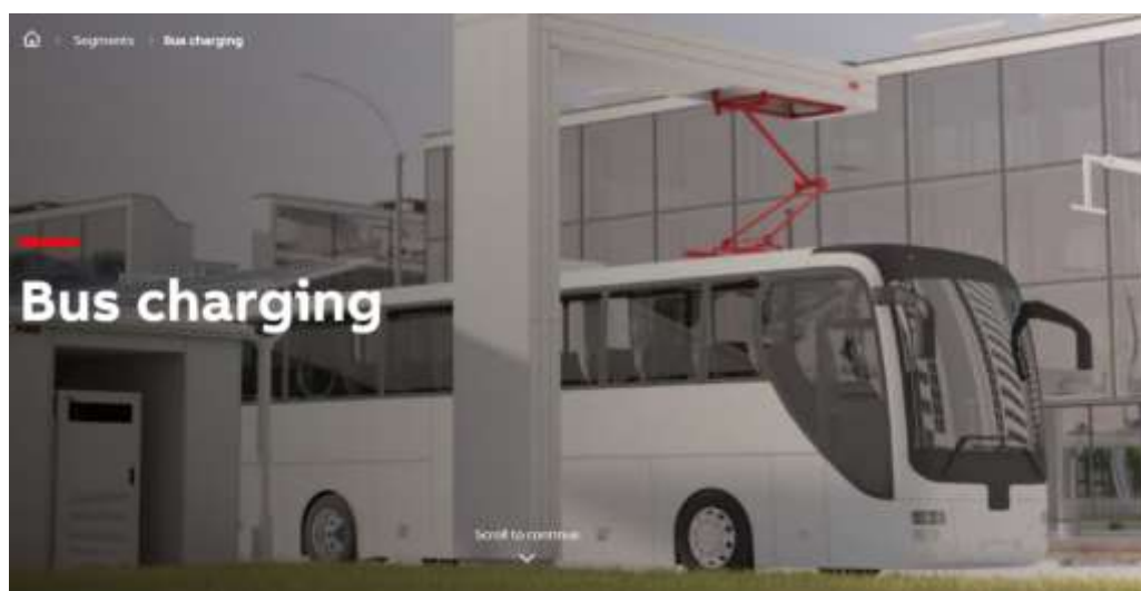
Figura 26: Estación de carga de bus eléctrico
